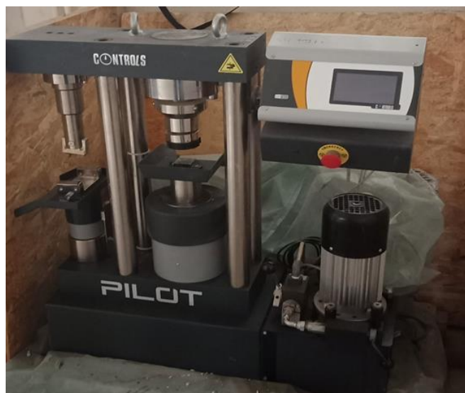
Figure II-27 : Dispositif expérimental de l'essai de compression
