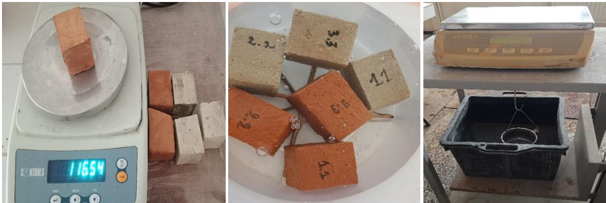
Figure II-24 : Pesée dans l'air et Pesée hydrostatique
