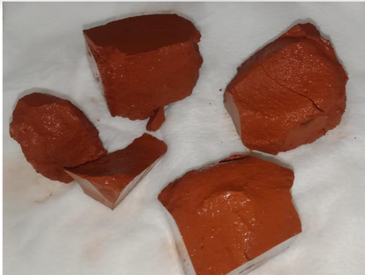
Figure II-26: Échantillons de pâte de brique dégradés dans l'eau
