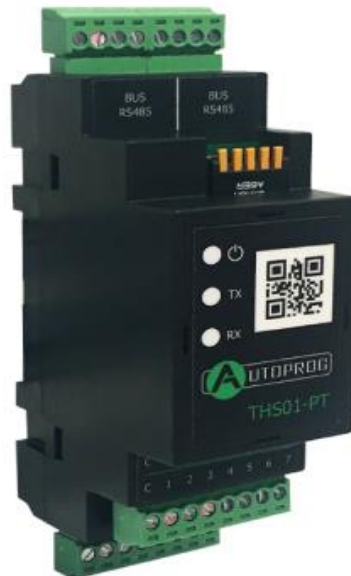
Figure III.1 : Le module THM01 d'acquisition de température.
