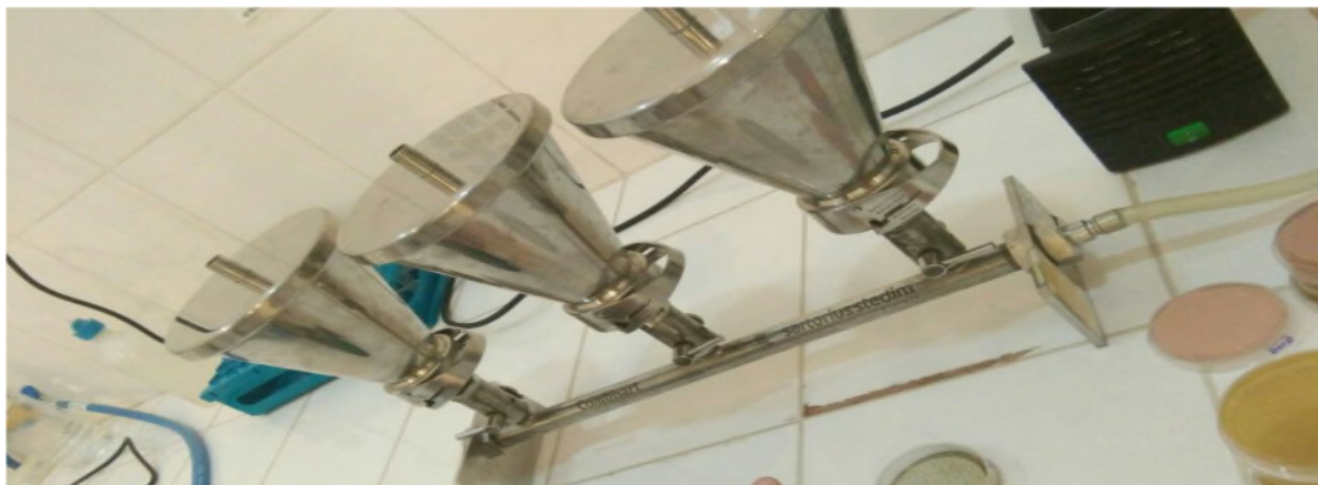
Figure II-20 : Rampe de filtration pour les analyses bactériologiques (Laboratoire de l'ADE).
