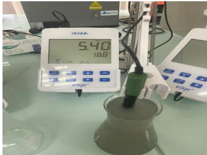
Figure II.13 : Mesure de l'oxygène dissout avec le l'oxymètre.
