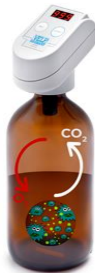
Figure II.18 : Principe de la mesure de la DBO 5 .
