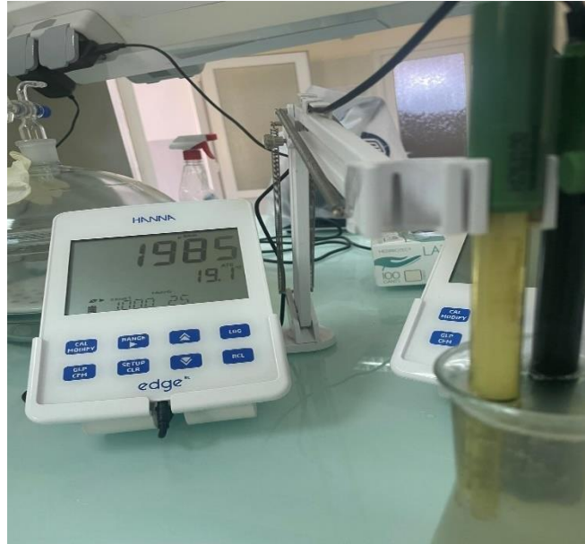
Figure II.12 : Mesure de la conductivité électrique CE avec un conductimètre.
