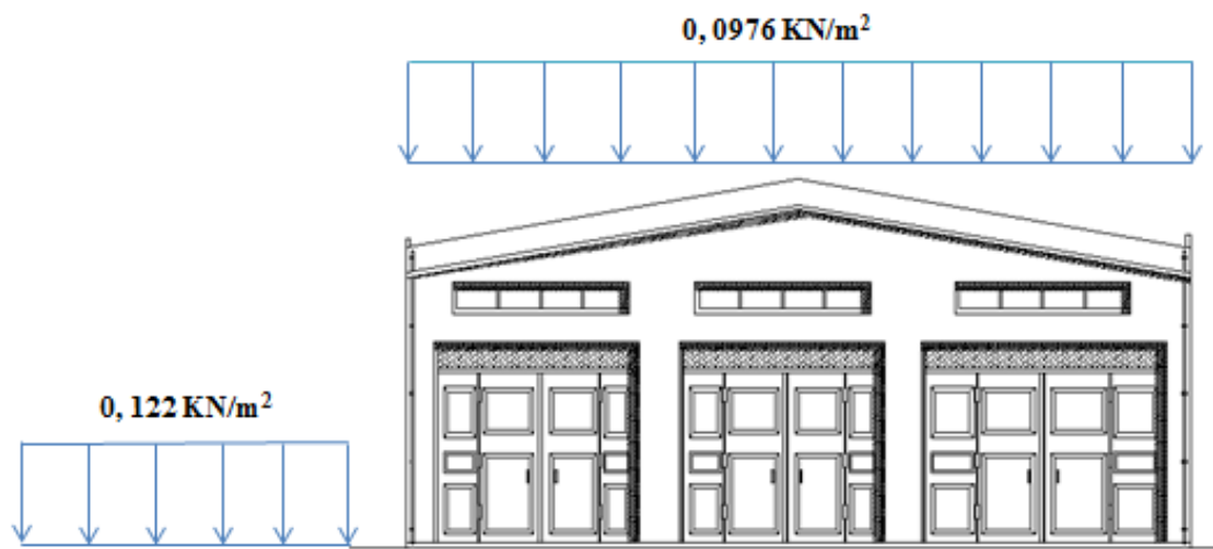
Figure II-2: Charge de la neige sur la toiture.
