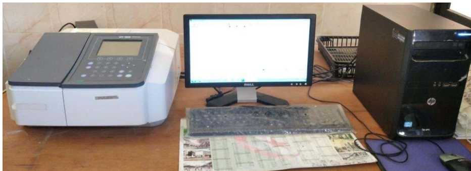
Figure II.2. Le spectrophotomètre UV-Visible utilisé pour mesurer les absorbances des solutions préparées.
