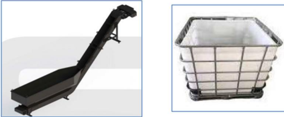
Figure.2.11 : Convoyeur d'enlèvement des cendres et Chariot de cendres (CINTECH, Département technique, 2023).
