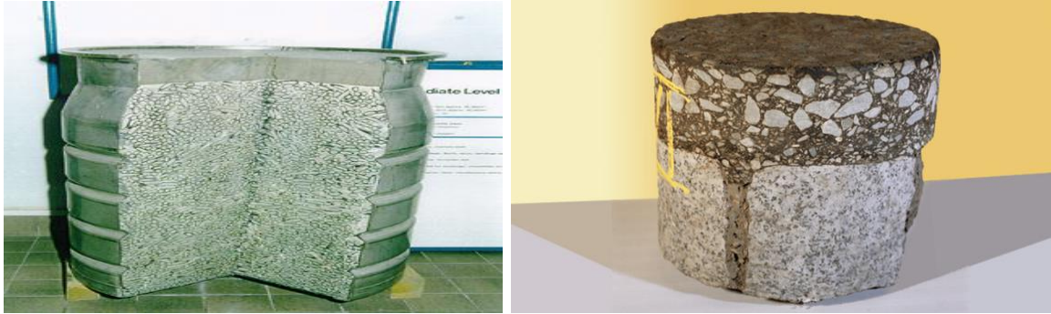
Figure 1.2 : Solidification des déchets par liants hydrauliques et par liants organiques (Walter,2010)
