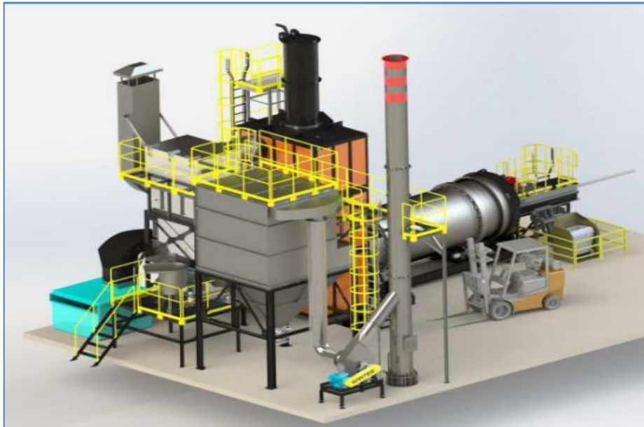
Figure 2.6 : Système d'incinération des déchets dangereux. (CINTECH, Département technique, 2023).
