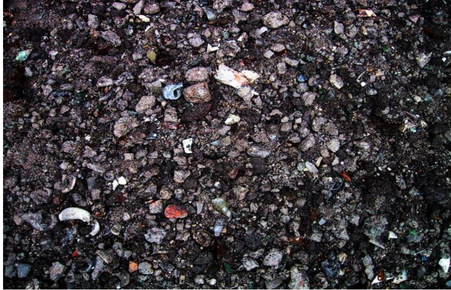
Figure 1.10 : Mâchefers d'incinération des déchets industriels (Walter,2010)
