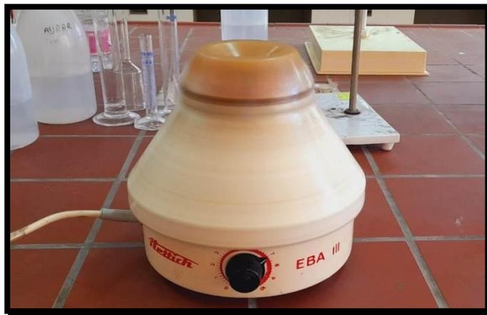
**Figure III.3 :** Centrifugeuse *HETTICH EBA III*.
