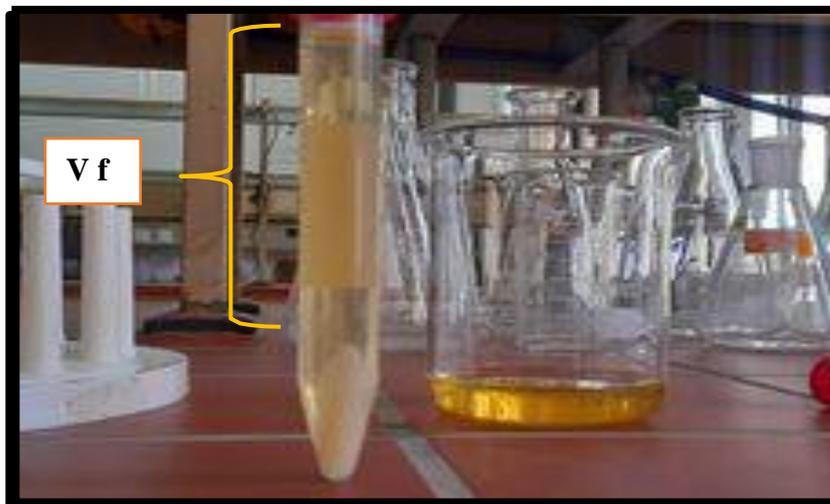
Figure III.3: le volume du filtrat obtenu après centrifugation.
