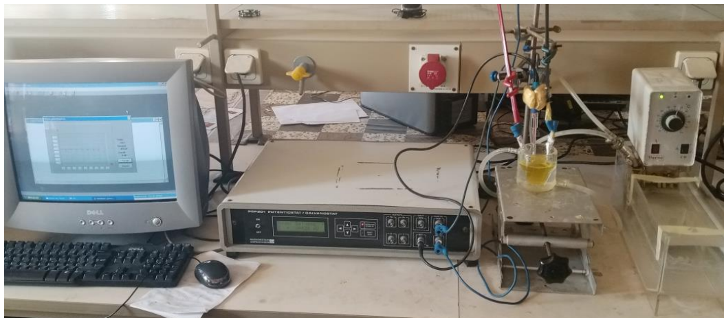
Figure II.6: Dispositif expérimental de mesure potentiodynamique, potentiostatique et galvanostatique.
