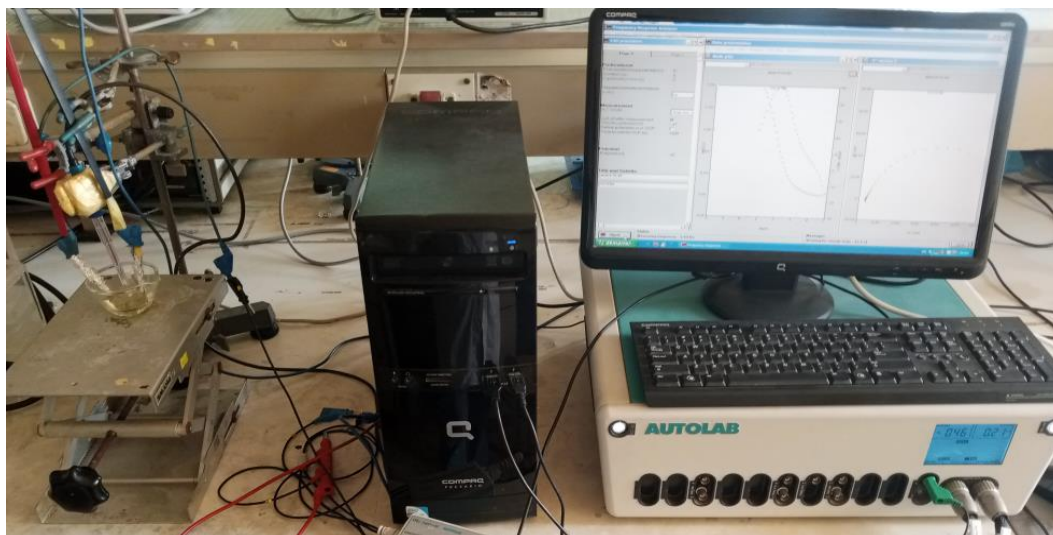
Figure II.7 : Dispositif expérimental AUTOLAB de mesure d'impédance Electrochimique.
