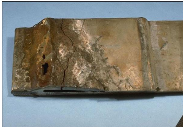
Figure I.5 : la corrosion sous contrainte
