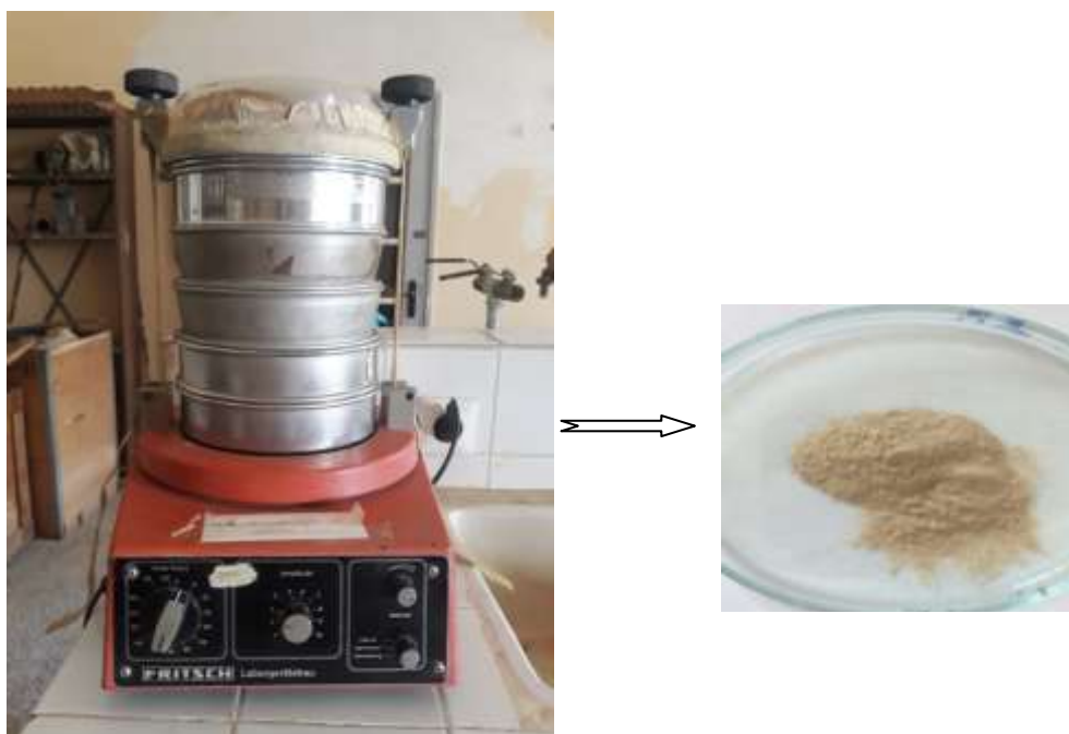
Figure III.8: Tamis vibreur électrique utilisé pour le tamisage.
