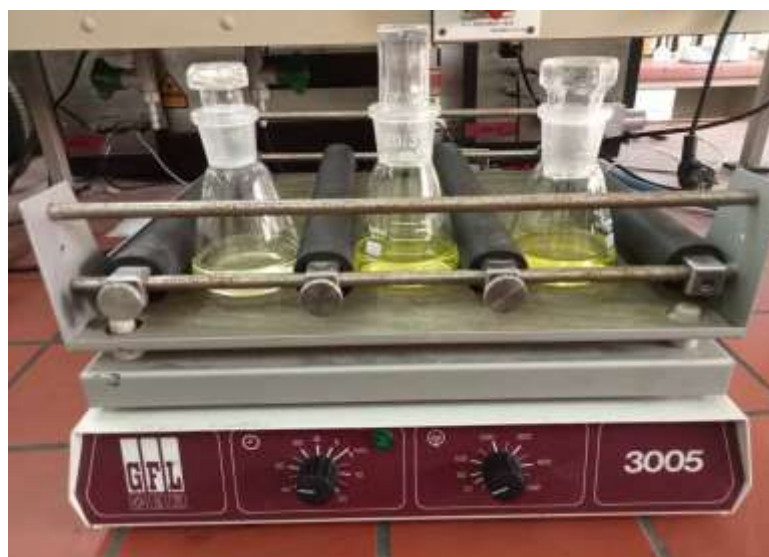
Figure III. 15: Dispositif expérimental d'adsorption en mode batch
