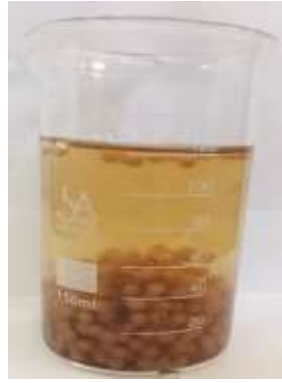
Figure III.10: Billes ALG/EPT précipitées dans une solution de chlorure de calcium(en cours de maturation).
