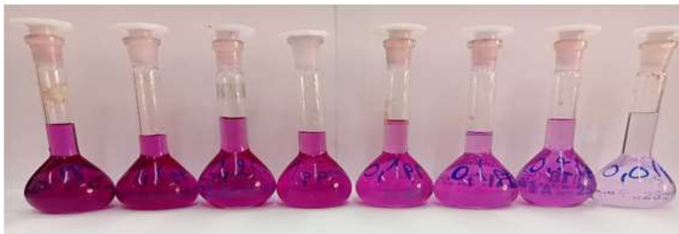
Figure III. 2: Les échantillons de la courbe d'étalonnage.
