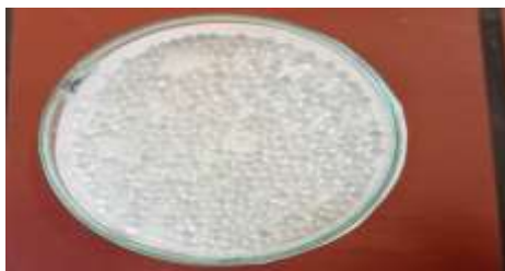
Figure III.9: Billes d'alginate sous forme "hydrogels".
