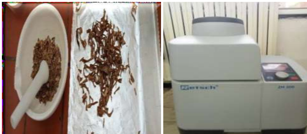
Figure III.7: Broyeur utilisé pour le broyage.
