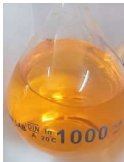
Figure III. 1: Préparation de la solution mère de Cr (VI).
