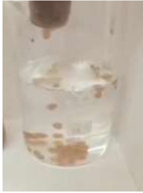
Figure III.10: Billes ALG/EPT précipitées dans une solution de chlorure de calcium(en cours de maturation).
