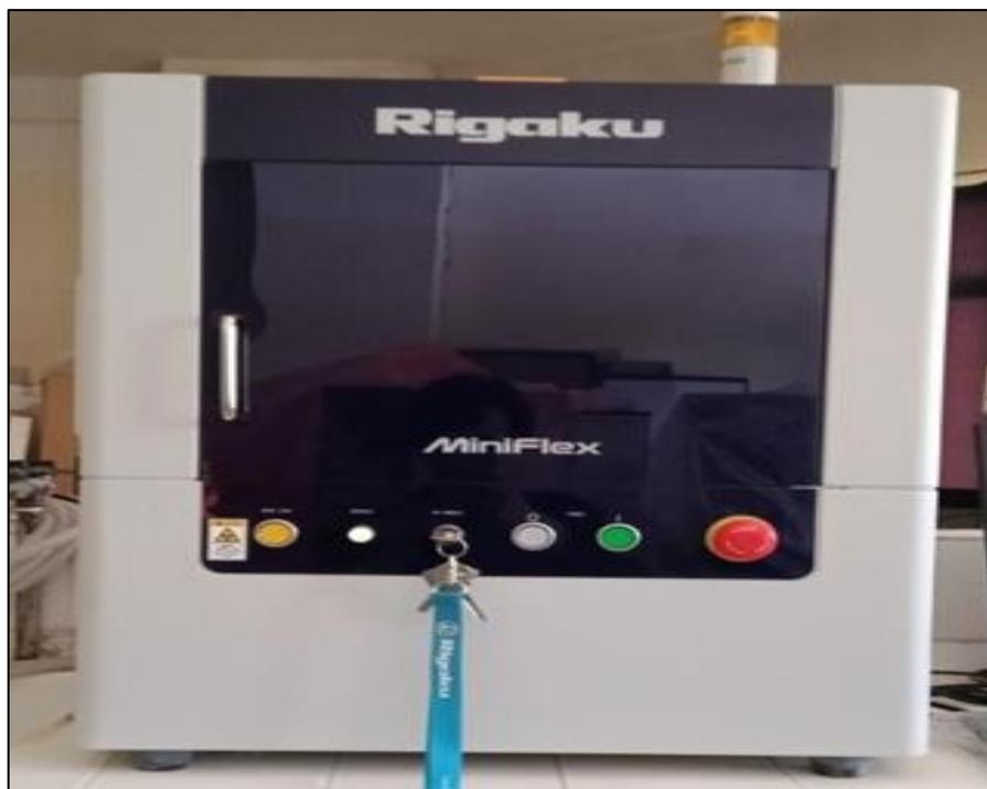
**Figure 21:** Diffractomètre Miniflex Rigaku.
