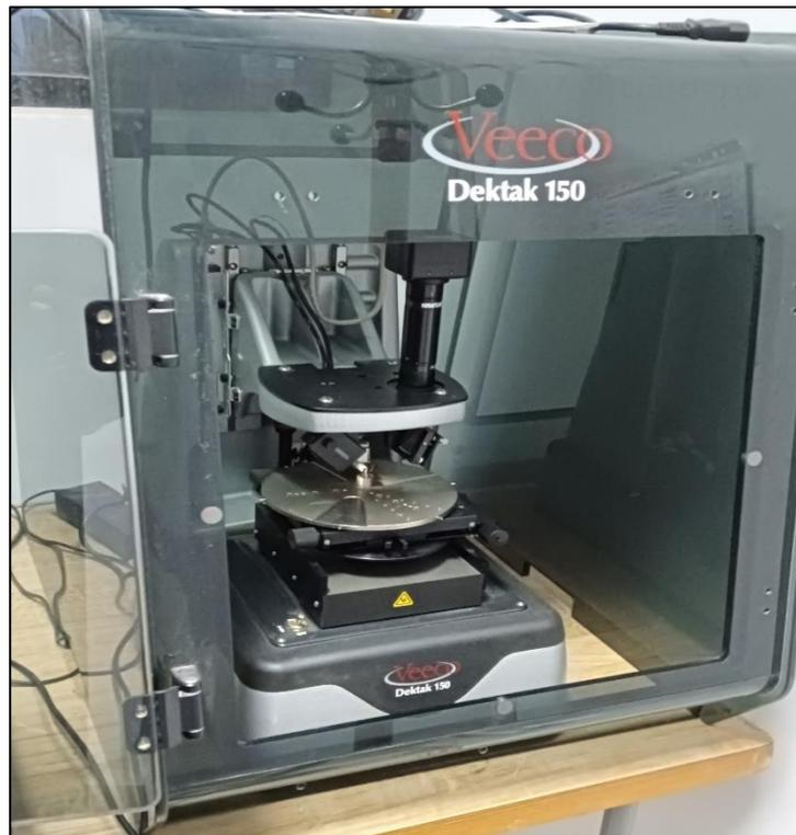
**Figure 25:** Profilomètre de type VEECO DEKTAK 150.
