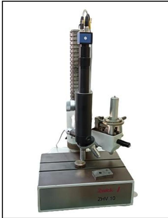
**Figure 26:** Microduromètre type ZWICK ZHV 10.
