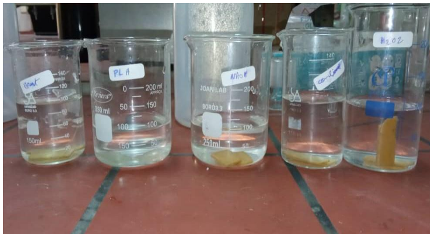
Figure II.13 : Étapes pour déterminer le taux d'absorption d'eau.
