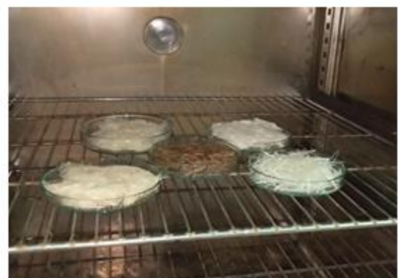
Figure II.11: Étapes pour déterminer le taux d'humidité des fibres de malva.
