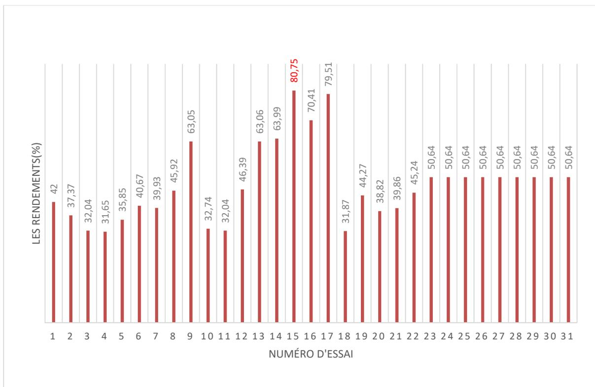
**Figure V.5 :** Les rendements d'élimination du colorant AB
