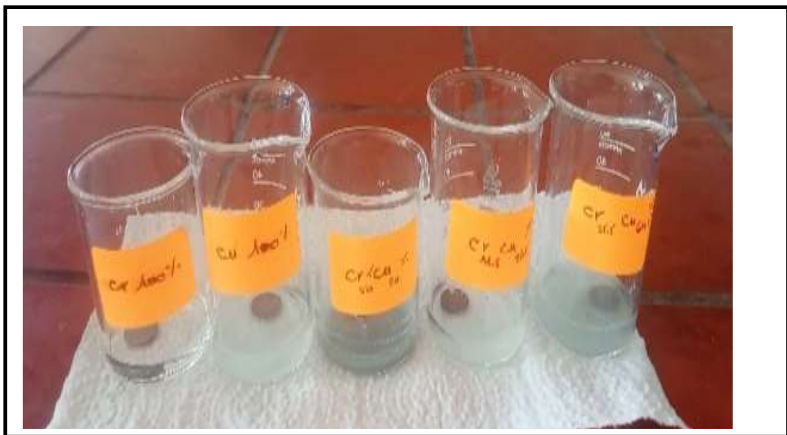
Figure III.18 : Les échantillons émergés dans la solution NaCl, après la corrosion.
