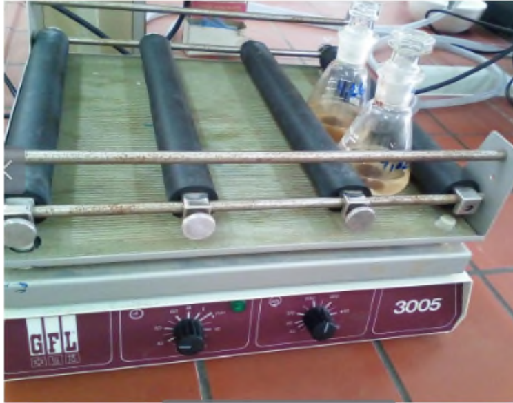
Figure (IV. 8): Dispositif expérimental d'adsorption en mode batch
