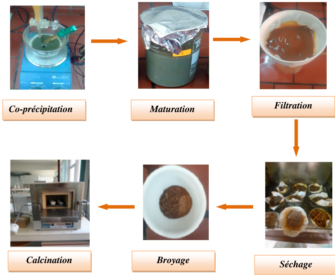
Figure (IV.6): Les étapes de préparation de l'adsorbant
