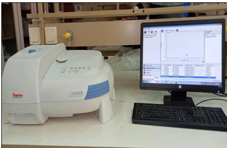
Figure (IV.3): Spectromètre UV-visible utilisé pour mesurer les absorbances des solutions préparées.
