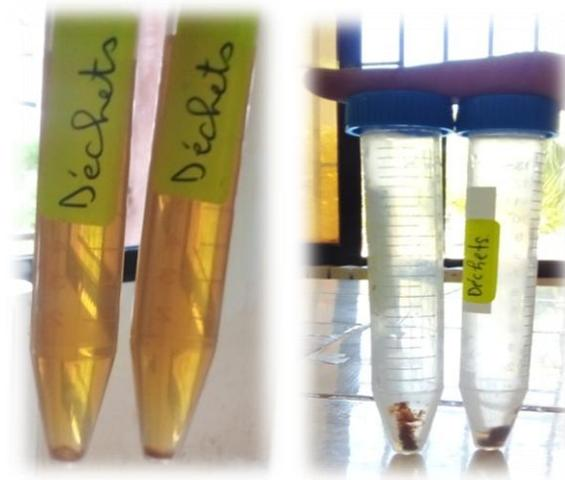
**Figure V.1:** Synthèse des nanoparticules d'argent.
