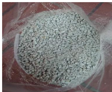
Figure II.6. : DEEE à l'état granulaire après broyage.
