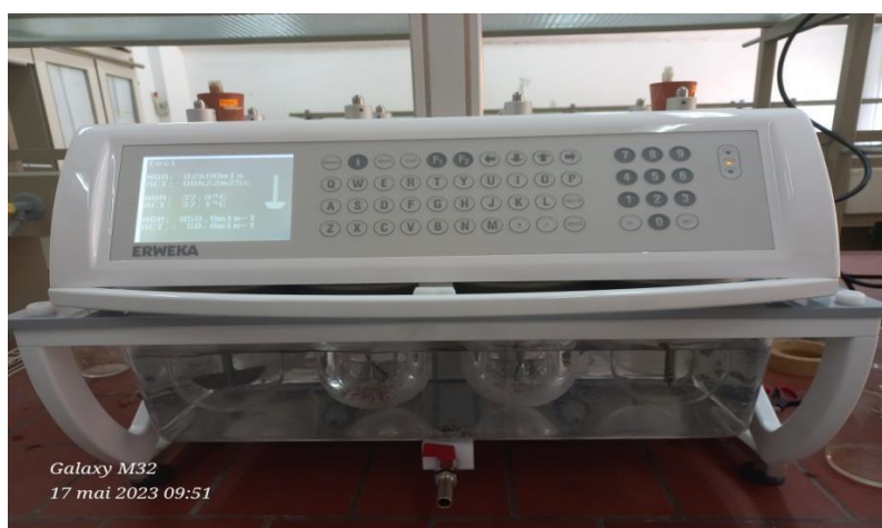
Figure III.28 : installation du dissolu test mise en œuvre pour l'étude de la cinétique de libération
