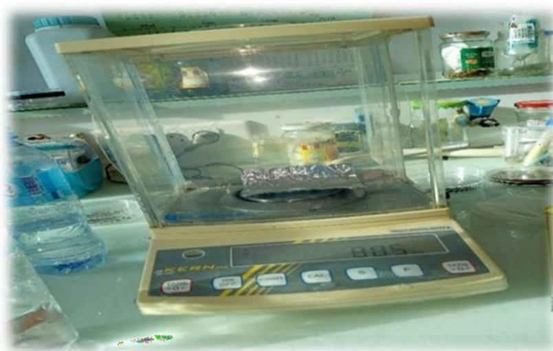
**Figure18 :** Balance magnétique (0.1mg)
