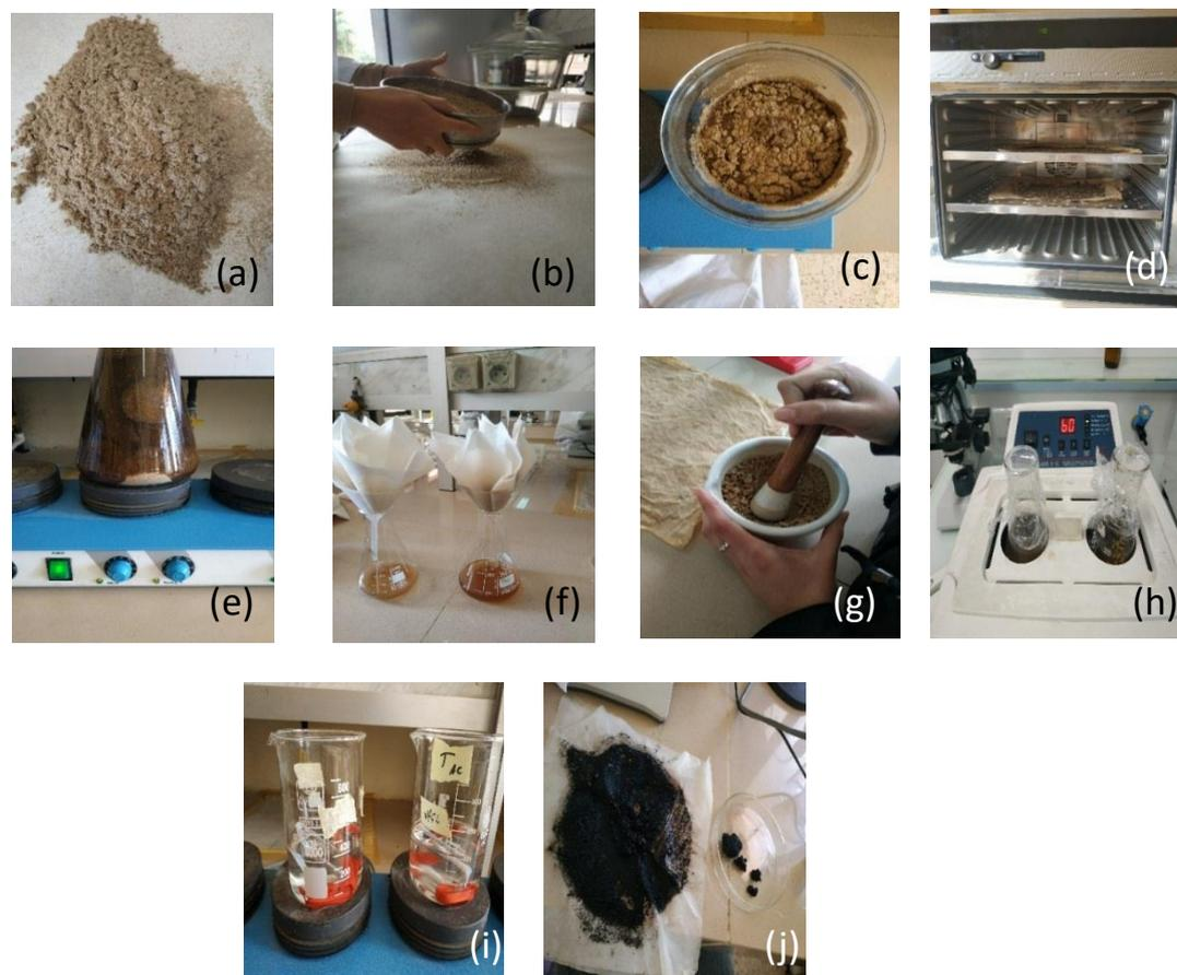
**Figure 3.** *Étapes de synthèse du matériau : (a) : broyage de la coque de MO, (b) : Tamisage de la poudre de MO, (c) : ébullition du mélange eau-poudre, (d) : séchage du mélange, (e) : traitement avec NaOH et NaCl, (f) : filtration ; (g) : broyage après séchage de la poudre blanchie, (h) : traitement ultra-sons, (i) : dialyse, (j) : stockage après lyophilisation.*
