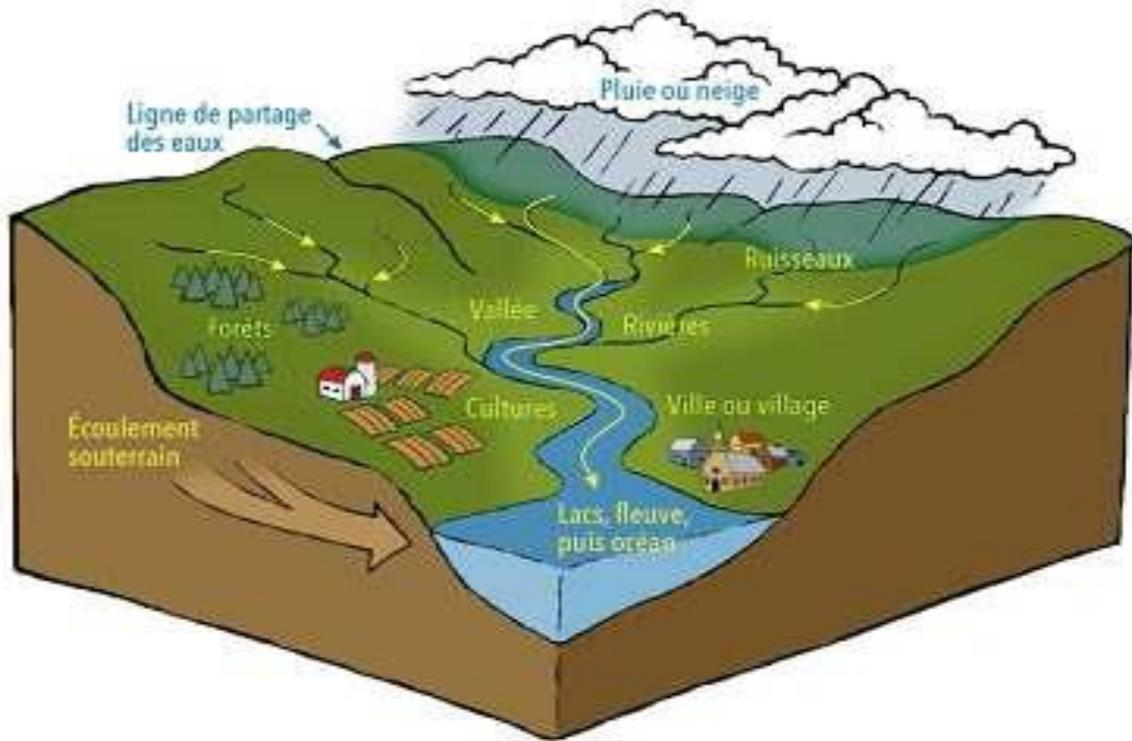
**Figure 3 : schéma d'un bassin versant**
