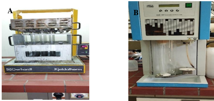
Figure 15 : photographie A-B des appareils de minéralisation et de distillation UDK 142 (VELP).
