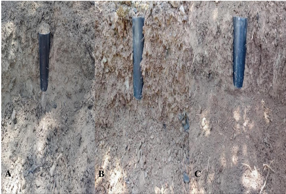
Figure 9 : Méthode de prélèvement par les cylindres (A : Sol sableux, B : Sol limoneux, C : Sol argileux)
