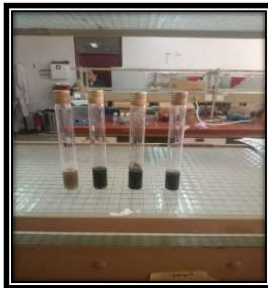
**Figure 6 :** Tubes à essais contenant les lixiviats
