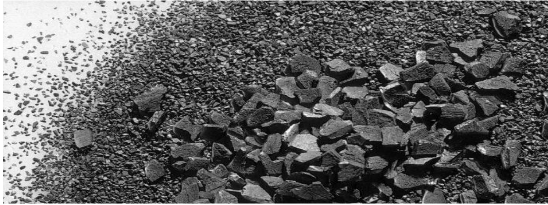
Figure I.9 : structure de charbon actif
