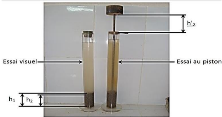
Figure II.10 : Essai d'équivalent de sable (visuel et avec piston)
