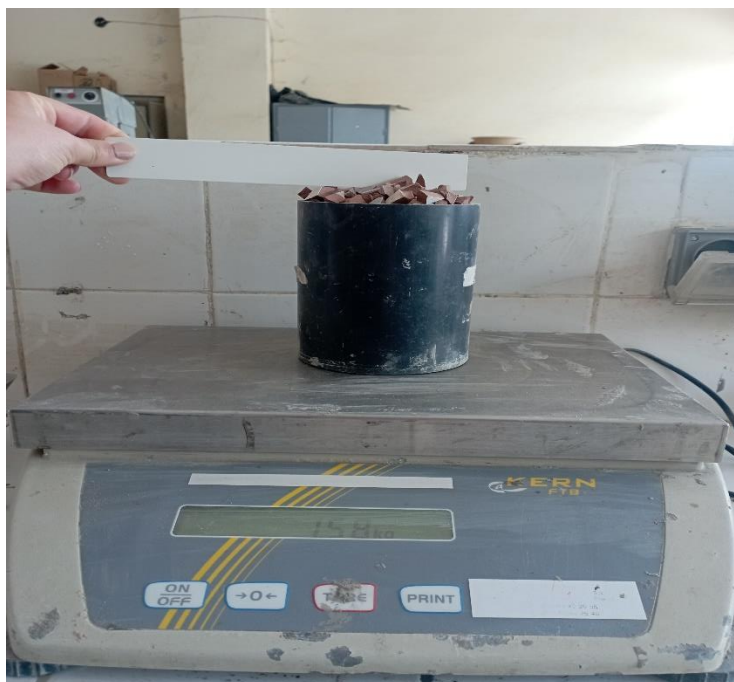
Figure II.9: Mesure de la masse volumique apparente.
