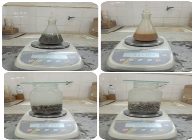
Figure II.7: Mesure de la masse volumique absolue des granulats au pycnomètre.
