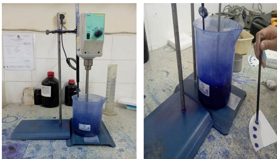
Figure III.6: Essai bleu de méthylène de sable.
