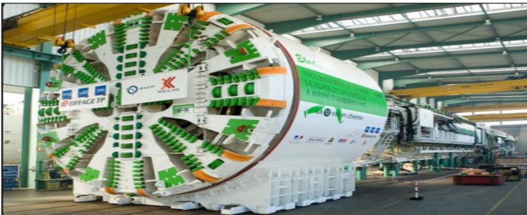
Figure I.1 Machine attaque globale (Creusement mécanique en terrains rocheux) [A]
