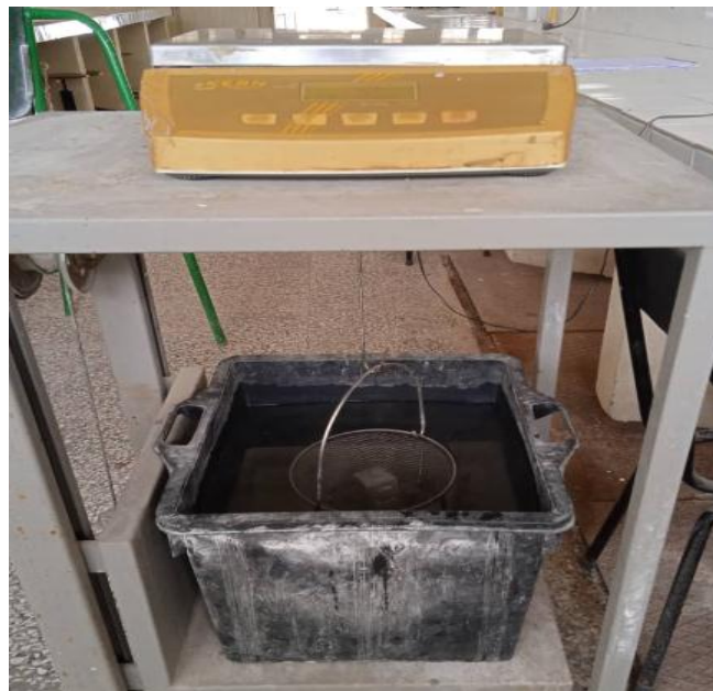
Figure III.11: Dispositif de la pesée hydrostatique
