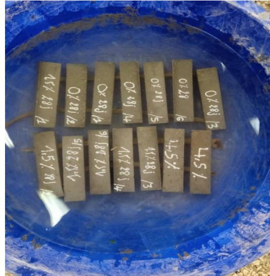
Figure III.10: Éprouvettes conservées dans d'un film plastique pendant 24h l'eau
