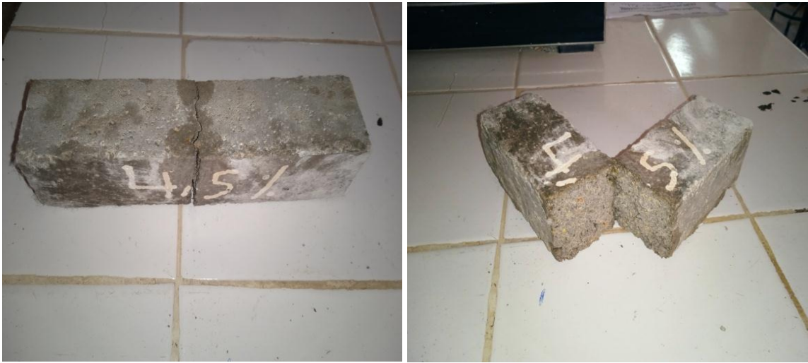
Figure III.30: Chemin de rupture d'échantillon avec 4,5% d'ajout.
