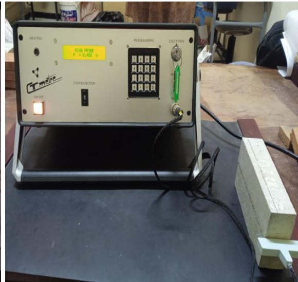
Figure III.32: Essai au CT-mètre.
