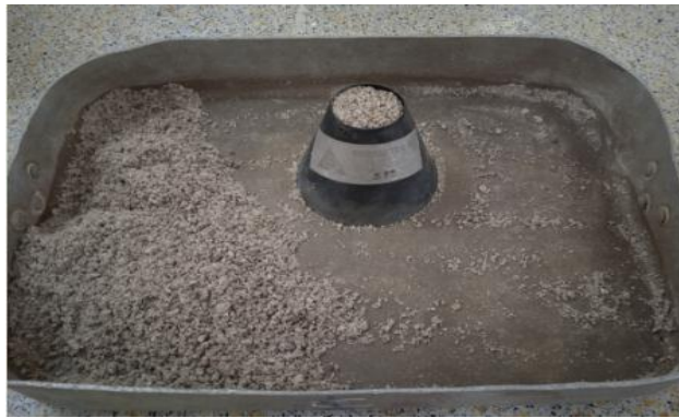
Figure II.11 : Remplissage du moule tronconique par la prise d’essai en cours de séchage
