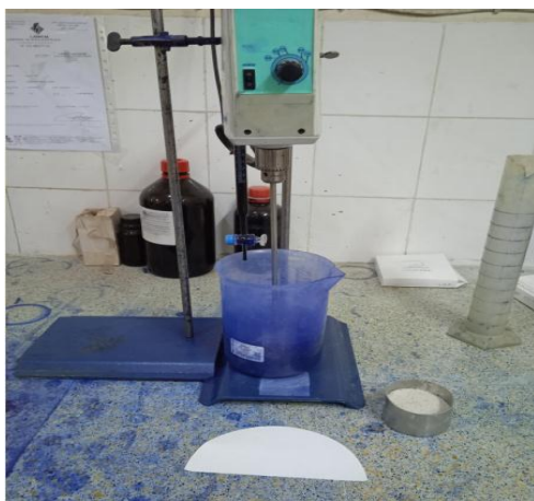
Figure II.8 : Malaxeur à deux vitesses lentes et rapides
