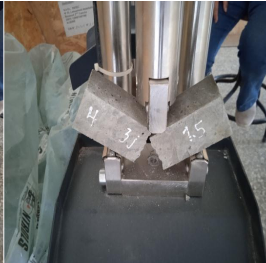
Figure III.24: Rupture de l'éprouvette.
