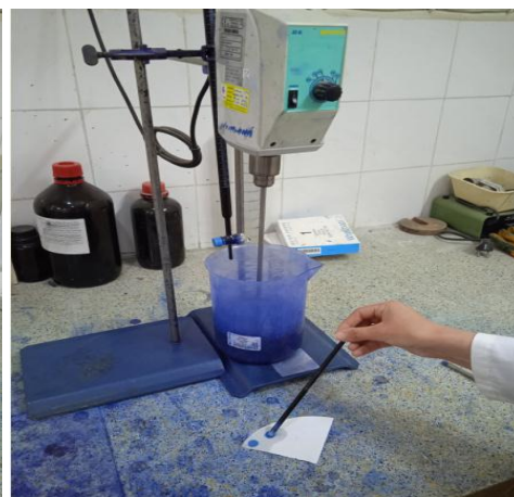
Figure II.9 : Application du bleu de méthylène sur le papier filtre
