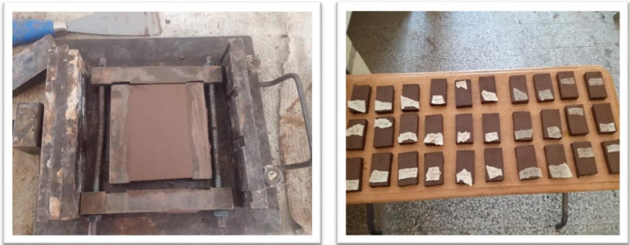
Figure III.3. Echantillon de briques façonnés à l'aide de malaxeur séchés à l'air libre.
