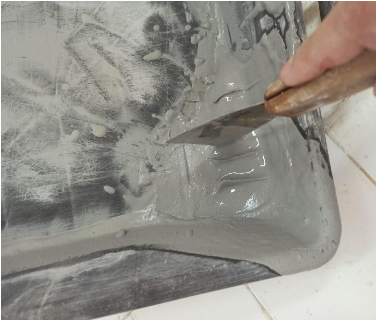
Figure III. 3. « temps-couteau » par la méthode de couteau
