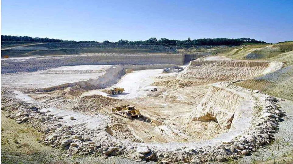
Figure I. 6. Extraction de gypse à ciel ouvert
