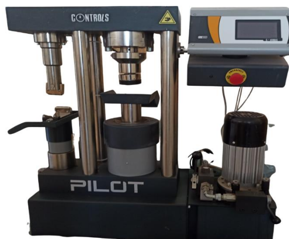
Figure II. 5. Presse hydraulique Control de type PILOT PRO modèle 65-L27P12
