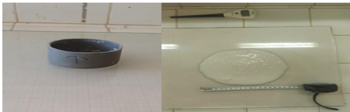
Figure II. 4. Moule en forme de cône en caoutchouc de 40 mm de hauteur et 75 mm de diamètre intérieur et la table d'étalement
