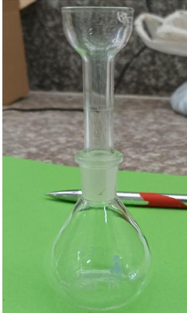
**Figure 2.8 :** aspect visuel du pycnomètre.
