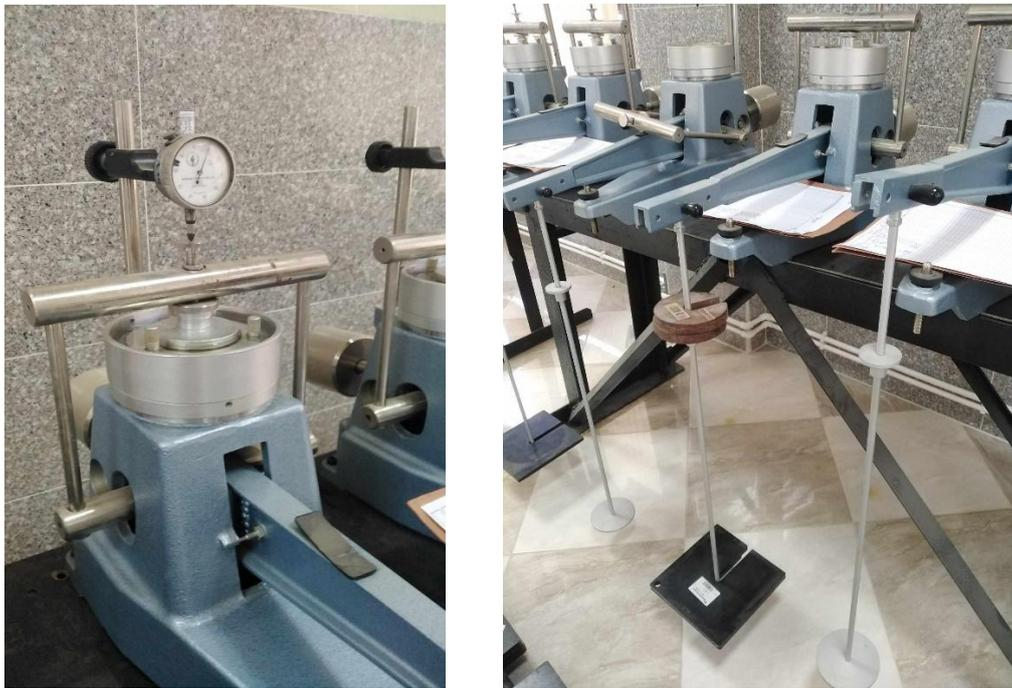
**Figure 2.16 :** immersion de la cellule œdométrique dans l'eau dans l'appareil œdométrique.
