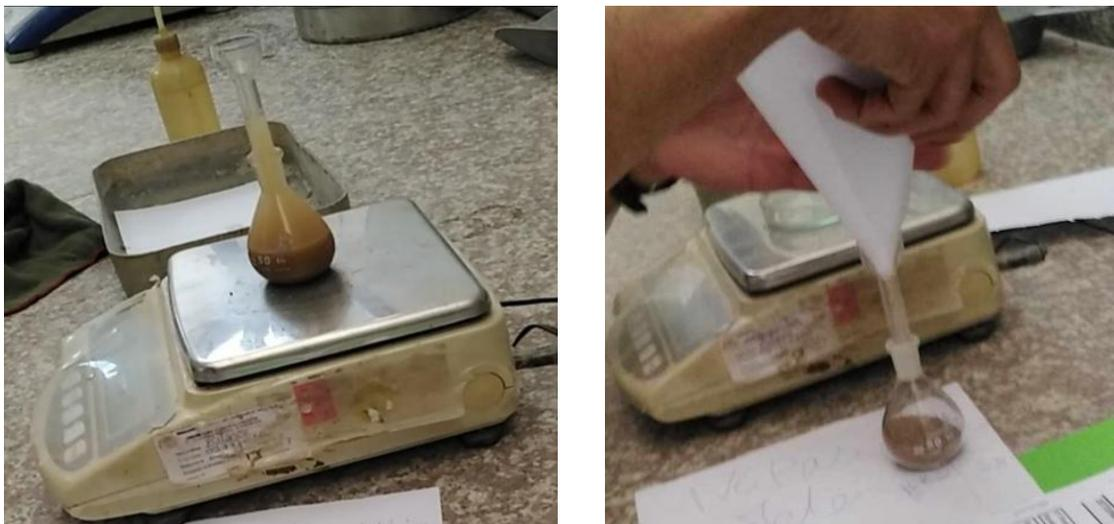
**Figure 2.9 :** essai de la méthode du pycnomètre a eau.
