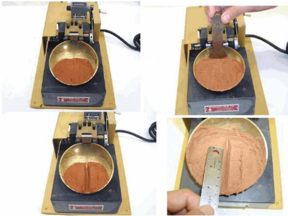
**Figure 2.13** : aspect visuel de l'essai pour la détermination de la limite de liquidité. [58].
