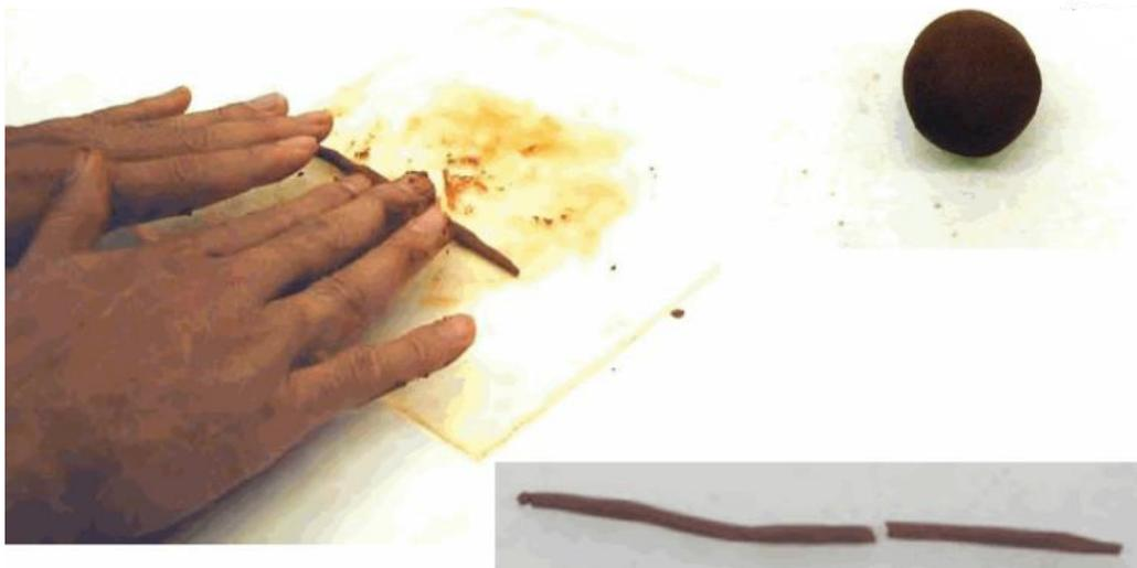
**Figure 2.14** : aspect visuel de l'essai pour la détermination de la limite de plasticité. [59].
