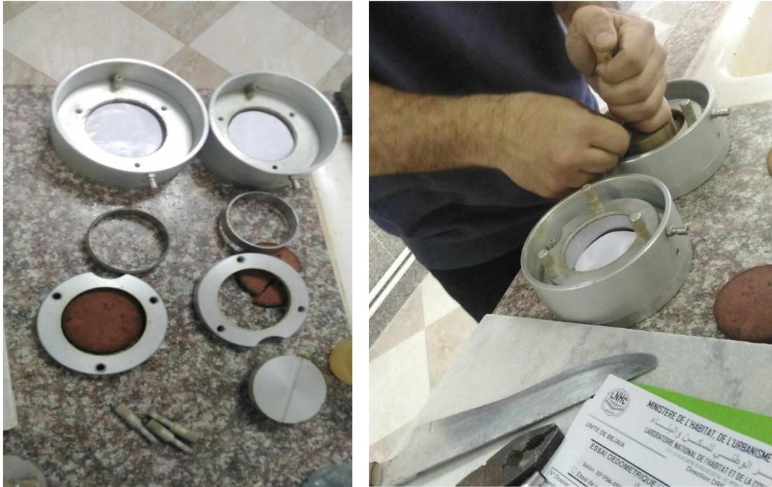
**Figure 2.15** : préparation de l'échantillon dans la cellule œdométrique.
