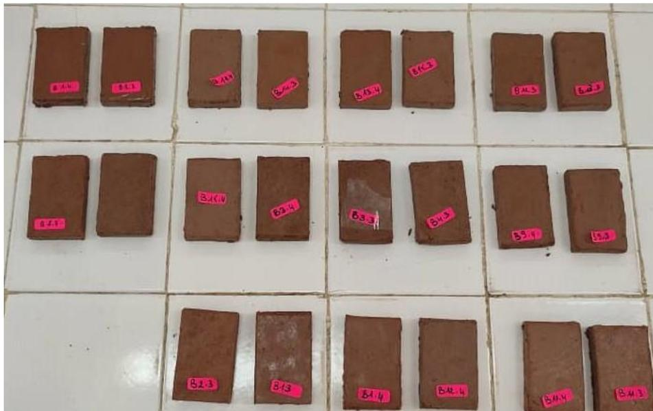
**Figure 2.20 :** aspect visuel de quelques éprouvettes après démoulage
