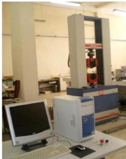
**Figure 2.23** : Machine d'essais IBERTEST
