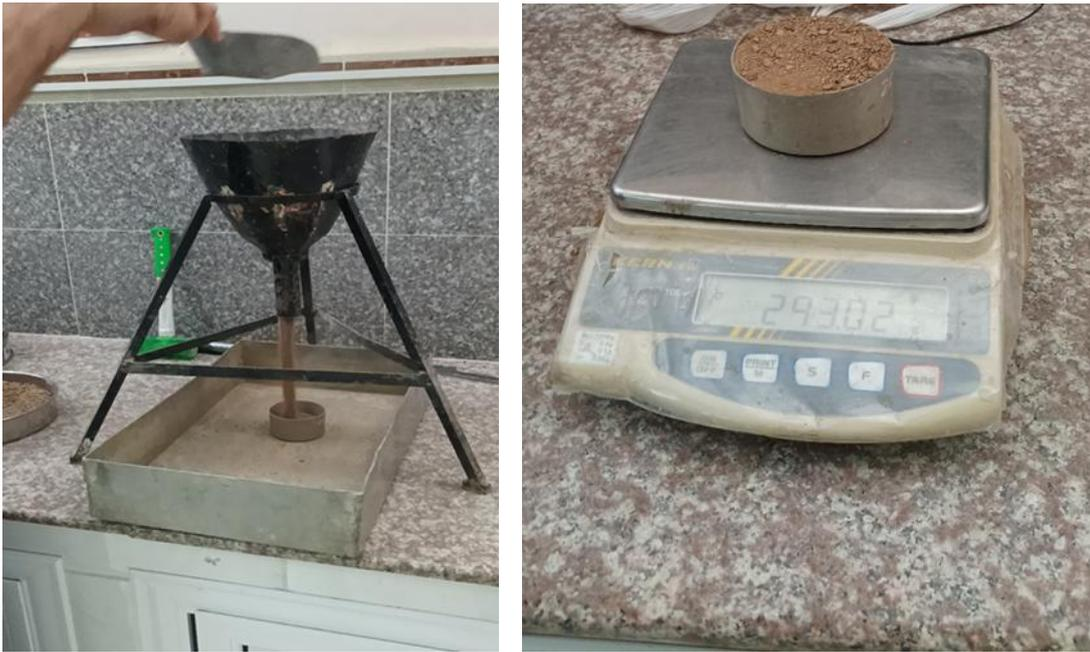
Figure 2.7 : essai de la densité sèche remaniée.
