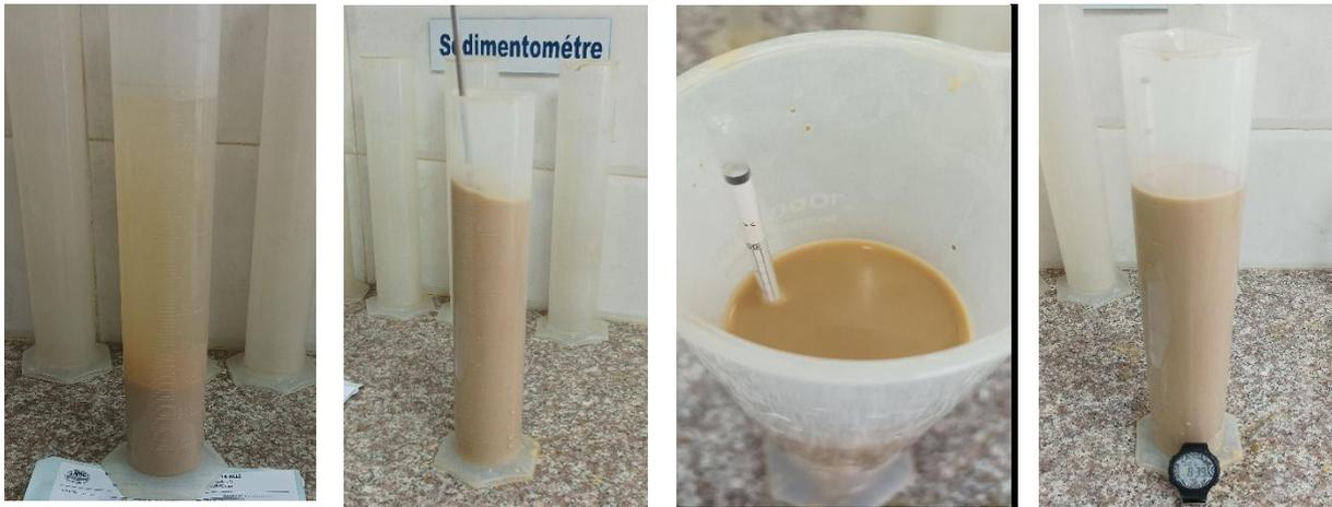
Figure 2.6 : méthode par sédimentation.
