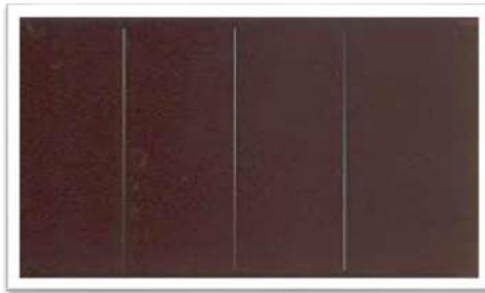
Figure 5 : Cellule photovoltaïque amorphe à couche mince.
