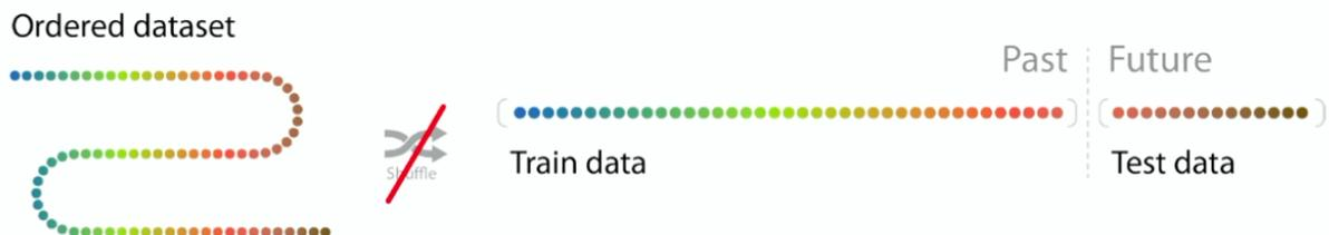
FIG. IV.7 : Principe de partitionnement des séries temporelles [37]
