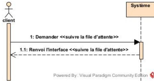
FIGURE 3.11 – Diagramme de séquence du cas d'utilisation « Suivre la file d'attente »
