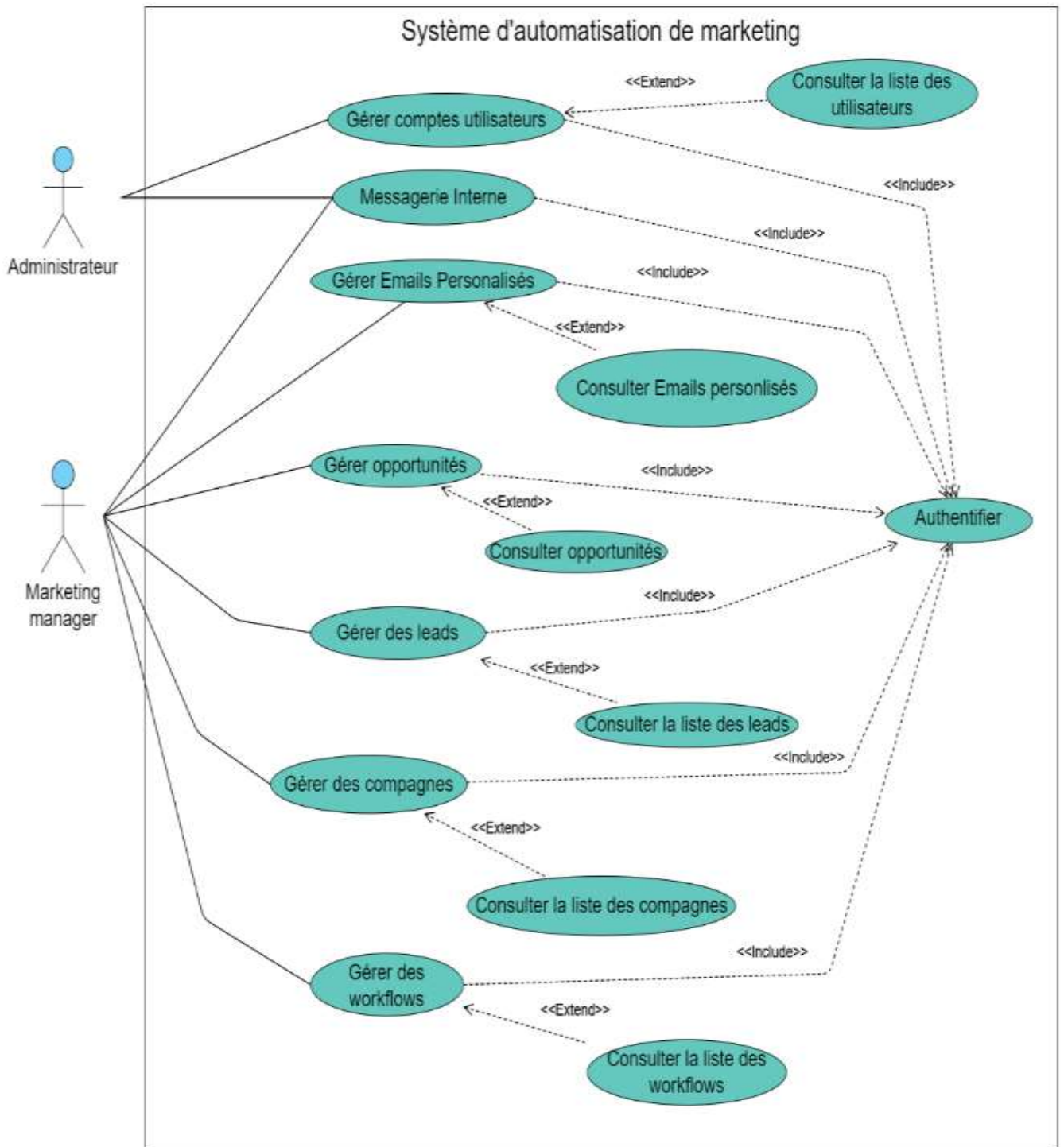
Figure 6: Diagramme de cas d'utilisations simplifier de système d'automatisation marketing SARL SPC GB
