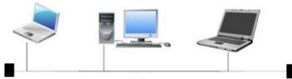
Figure 1.6 – schéma d'une topologie en bus.
