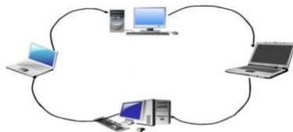
Figure 1.8 – schéma d'une topologie en anneau.
