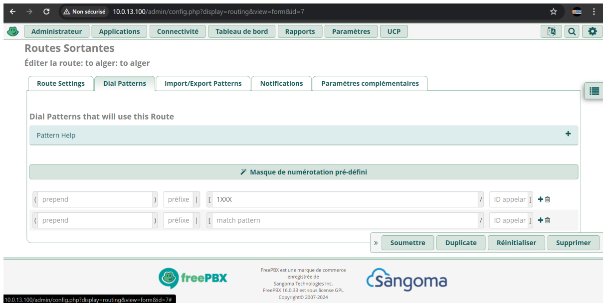
FIGURE 3.61 – Configuration de la route vers alger
