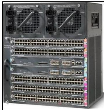
Figure II.6 : Switch Distributeur Cisco Catalyst 4507R [F9].
