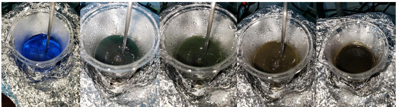
Figure II.1 : Photographie montrant le changement de couleur de la solution lors de la synthèse (de gauche à droite).
