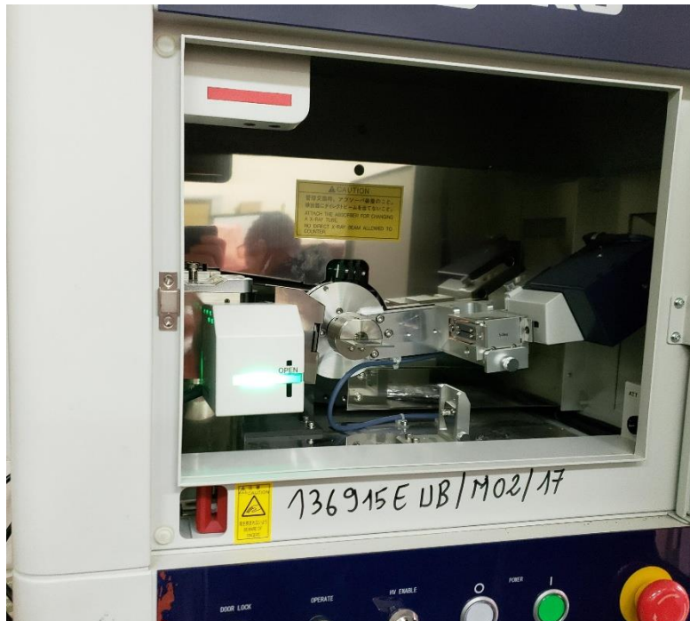
Figure II.6 : Photographie du diffractomètre à rayons X utilisé dans ce travail.
