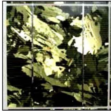
Figure I. 11 : Cellule PV poly-cristalline. Source : Wikipédia
