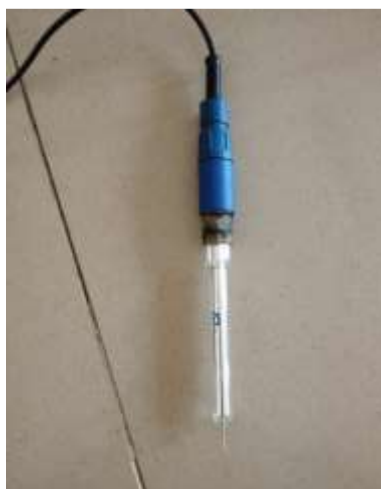
Figure II-8 : Contre électrode en platine.
