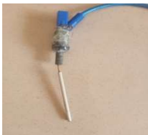
Figure II-6 : Électrode classique à cavité.
