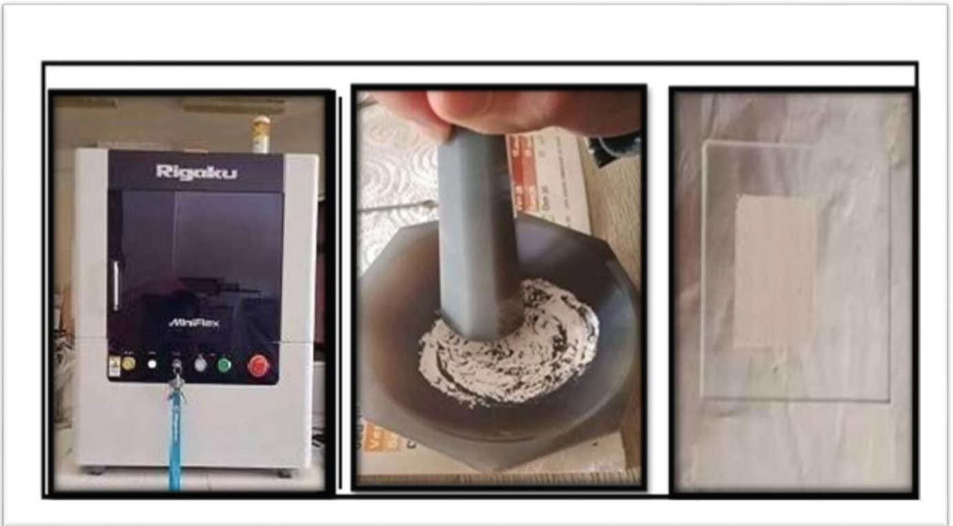
Figure II.8. Diffractomètre de rayons X de type Rigaku Mini-flex » (Laboratoire physico-chimique et catalyse)
