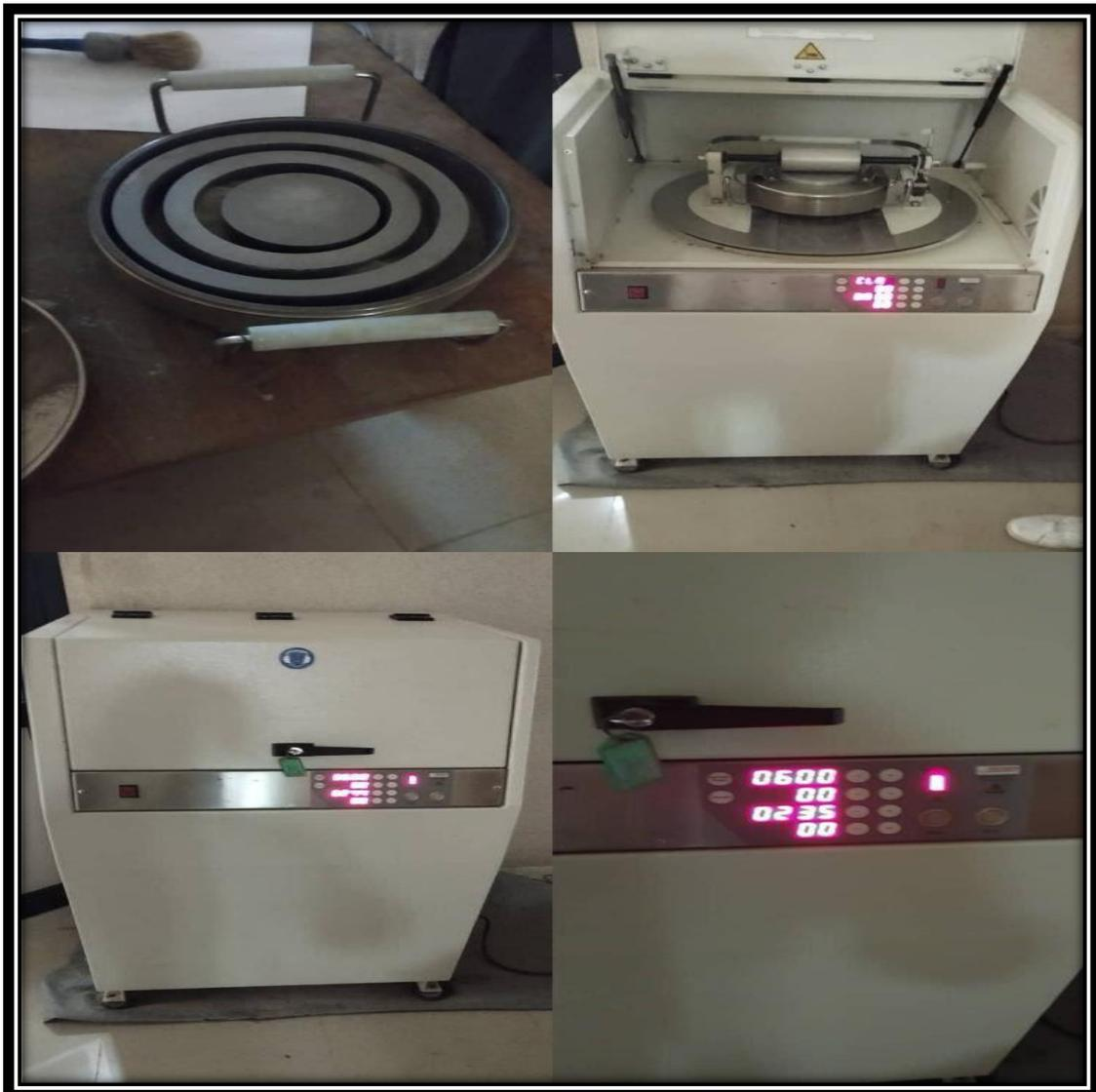
*Figure II-6 : Broyeur a disque.*
