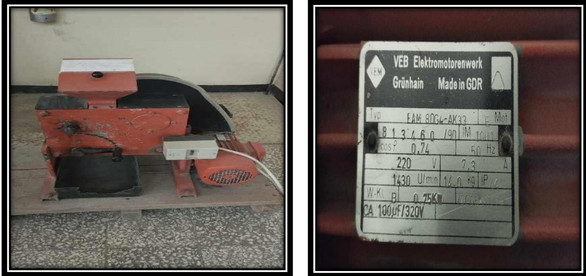
*Figure II-3* : Photo du concasseur a mâchoire (laboratoire du département).
