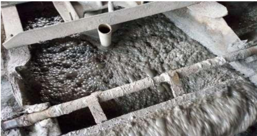
FIGURE 1.12 – Flottation de minerai de zinc de kherzet-youcef.
