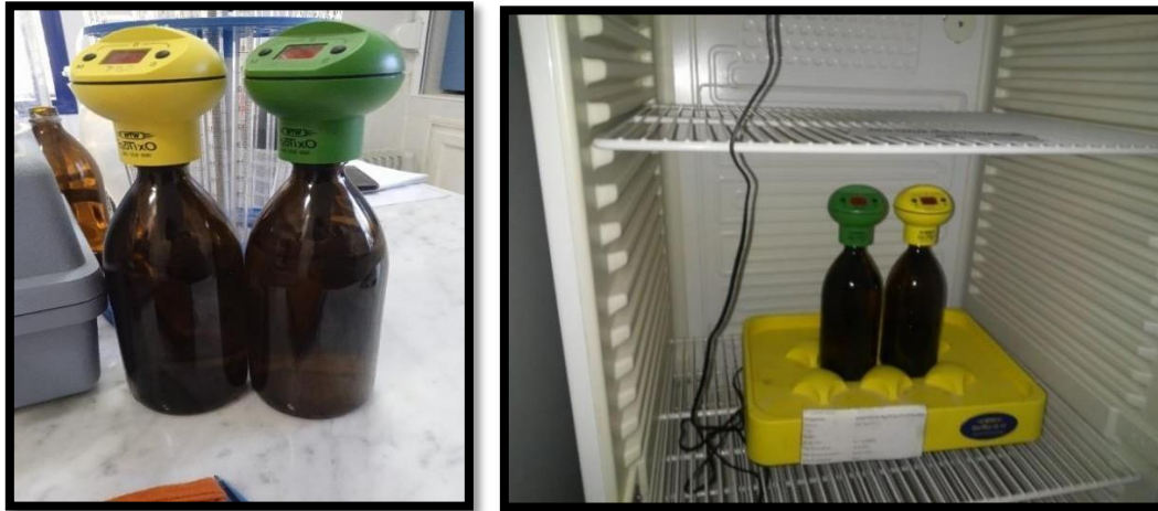
Figure II.7 : Dispositif de mesure de la DBO5 (STEP SAL 17/03/2024)
