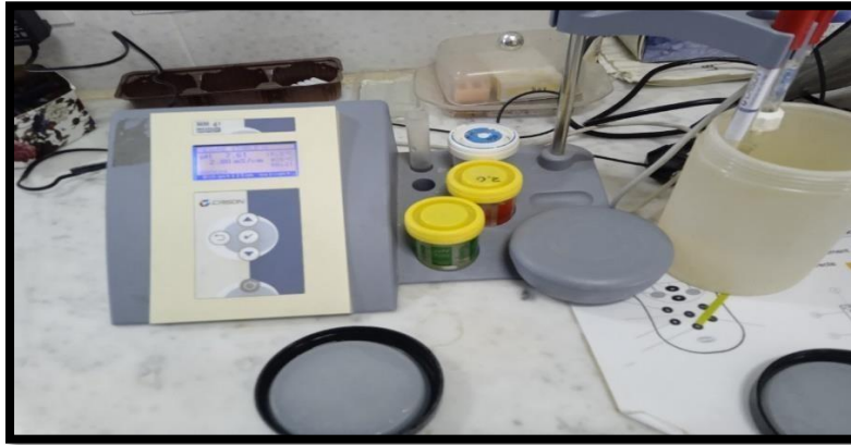
Figure II. 1 : Multi paramètre physico-chimique (pH, conductivité, température) (STEP SAL le17/03/2024)
