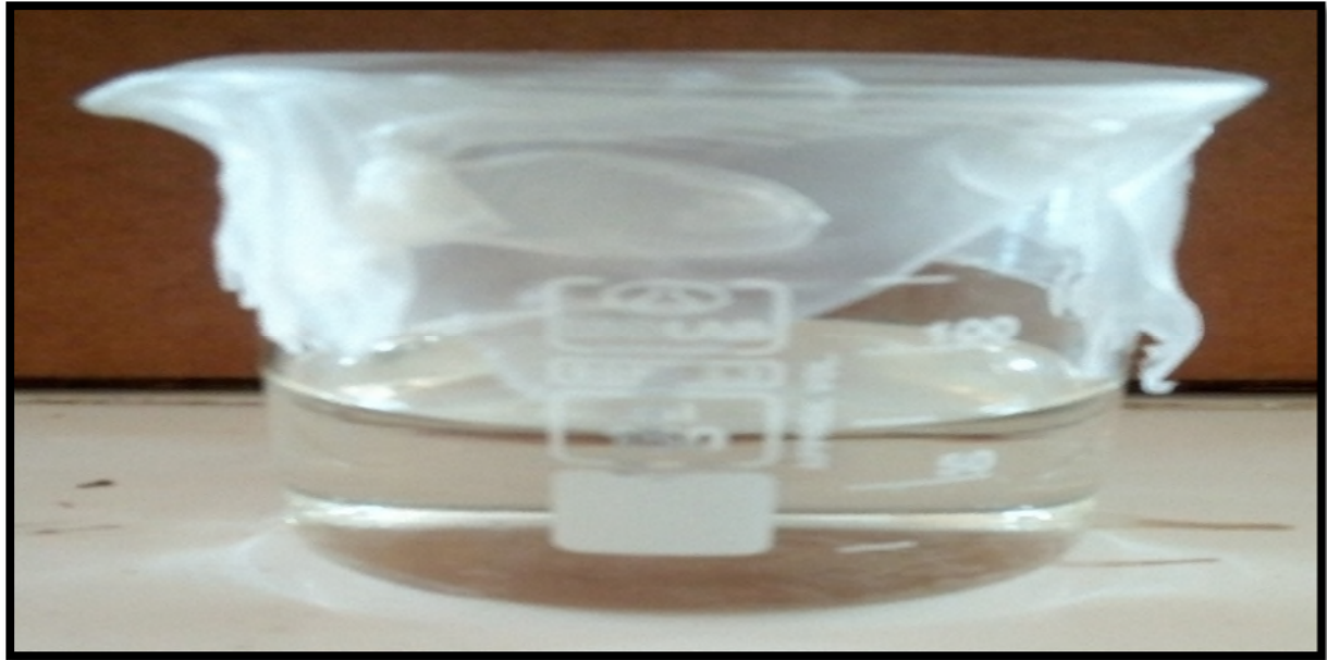
Figure II.12. La Solution obtenue de mélange de (TCLP + poudre minéral) après filtration (Photo prise au labo 21juin (2019)
