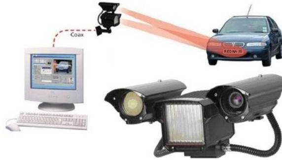
FIGURE II-2 – Les composants principales d'un ANPR
