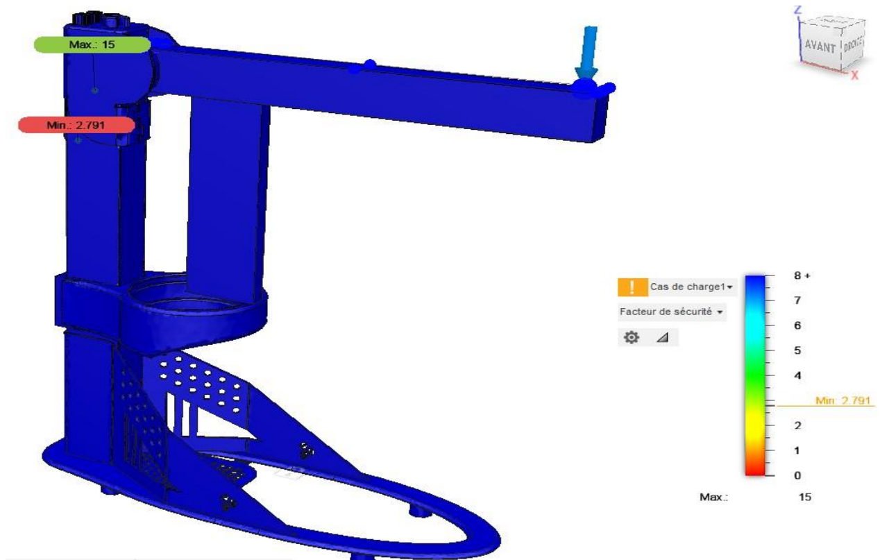
Fig III.2 résultat de simulation numérique du châssis.
