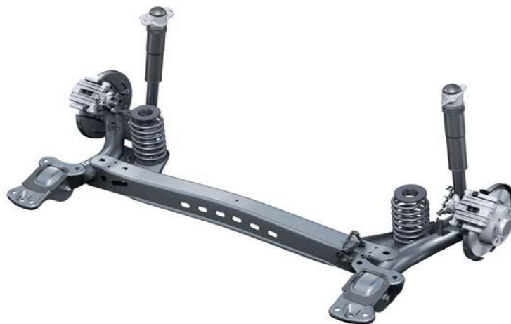
Figure I.12 : Suspension à ressorts hélicoïdaux d'un essieu rigide
