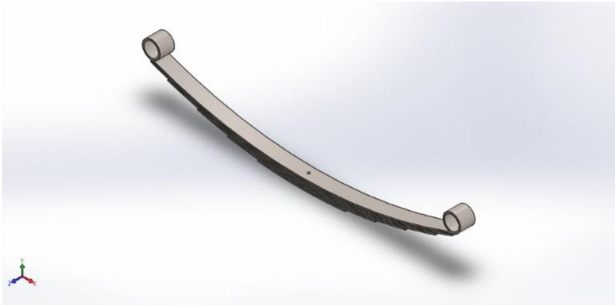
Figure III.3 : Ressort à lames multiples
