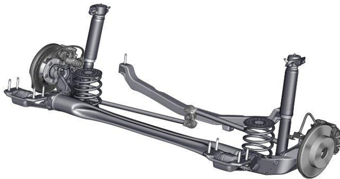
Figure I.10 : Système de suspension à barre de torsion
