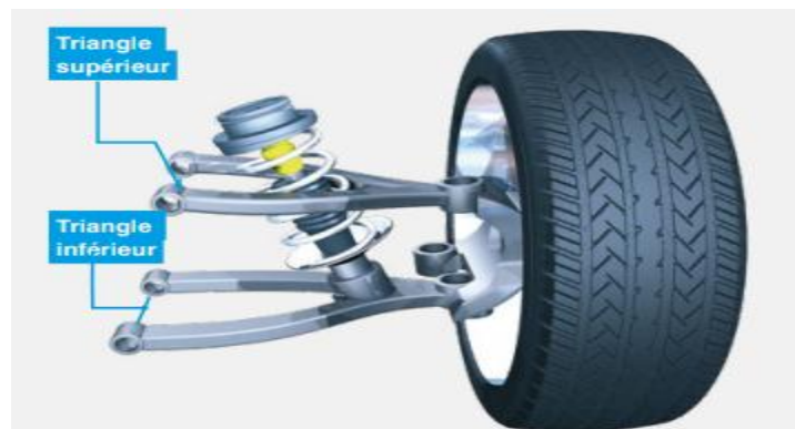
Figure I.8 : Système de suspension type double triangulation
