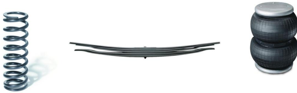
Figure I.1 : Les trois principaux types de ressorts
