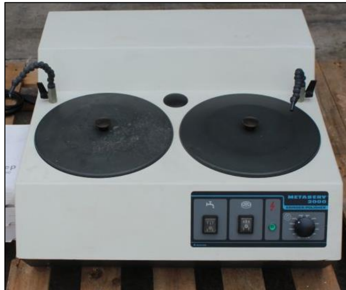
Figure II.4. Polisseuse mécanique de type METASERE 2000 situé au niveau de hall de technologie.
