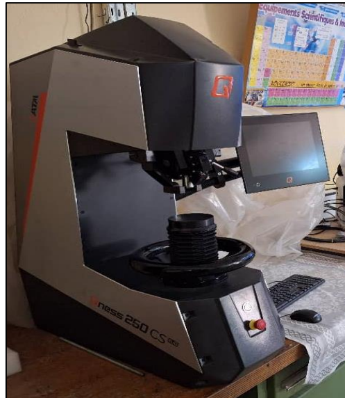
Figure II.6. Microduromètre de type Qness 250 CS Situé au hall de technologies.
