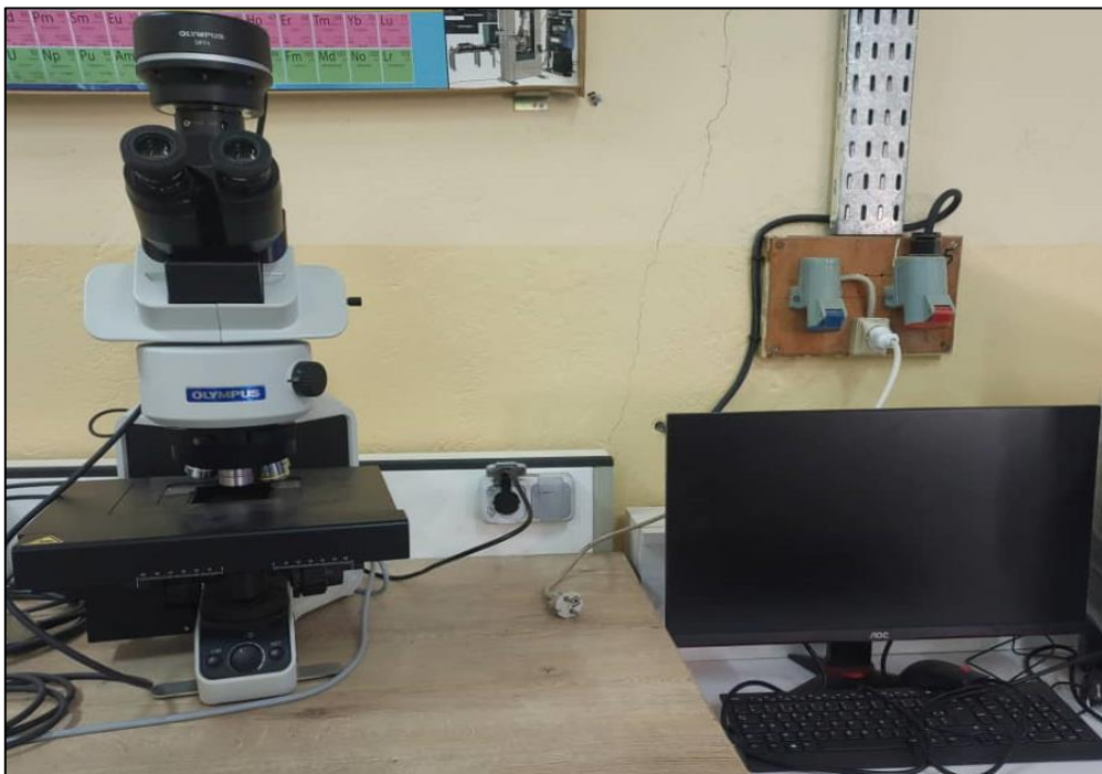
Figure II.3. Microscope optique de type OLYMPUS DP74 situé au niveau de hall technologie.
