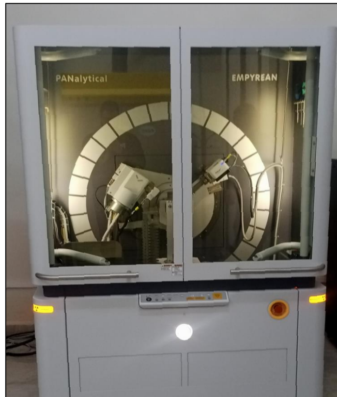
Figure II.5. Diffractomètre de type PANalytical EMPYREAN situé au PTAPC-CRAPC à l'université de Bejaia.
